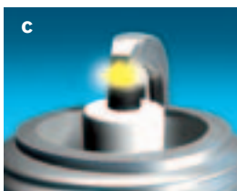
Geprofileerde massa-elektrode – middenelektrode
