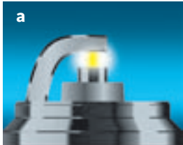
a Elettrodo a tetto – elettrodo centrale
