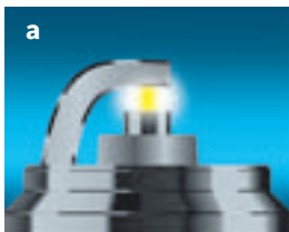
a Sřtečková elektroda – střední elektroda
